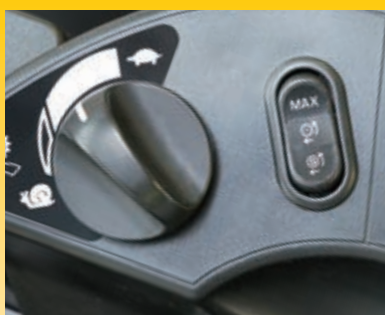
Quadrante di controllo con sistema di cambio velocità di traslazione a strisciamento (sinistra) e pulsante del sistema di controllo variabile della trazione (destra)
