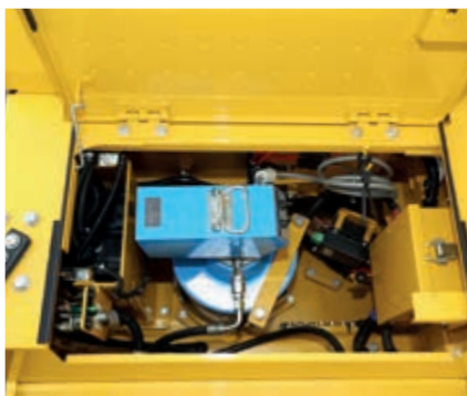
Pistola di ingrassaggio motorizzata dotata di rocchetto per il tubo
