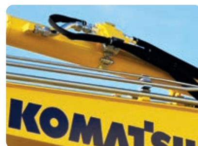
Valvole di sicurezza cilindri braccio e avambraccio
