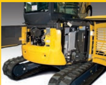
Cofani posteriori per controllo del motore, rifornimento carburante, ispezione e pulizia dei radiatori ed accesso alla batteria
