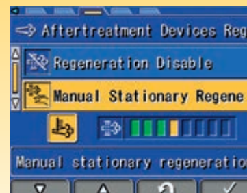
Schermata di rigenerazione del sistema post-trattamento per il DPF
