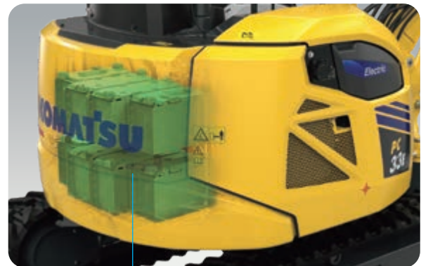
Area ad alta tensione
