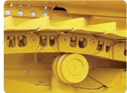
Le singole maglie possono essere sostituite utilizzando normali attrezzi per cingoli
