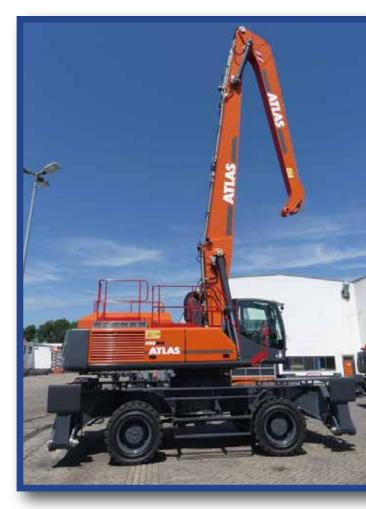
400 MH Peso operativo 40 – 41t Sbraccio max 18,2 metri Potenza 180 kW (245 HP)
